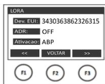
**LoRa:** Para visualización los parámetros de comunicación LoRa del medidor, como Device EUI, ADR (ON/OFF), Activación (ABP o OTAA), Clase (A o C), RSSI. El acceso se realiza a través del modo principal, haciendo clic en **MODO** hasta que aparezca en **LoRa** el botón derecho.
