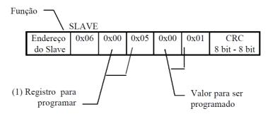
Para esta função o slave retorna uma cópia do comando recebido. No exemplo anterior o master programou o registro 40006 com o valor 00 01, tipo de ligação "00 – Três elementos, 4fios" e tempo de integração para cálculo de demanda de 1 minuto.
