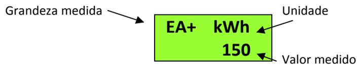
Os medidores possuem sistema inteligente de indicação, isto é, quando o valor de uma determinada grandeza ultrapassar seu limite, automaticamente a escala da unidade será aumentada, permitindo a visualização em proporção adequada.
