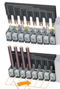
Tomada de tensão equipada com 2 terminais de ligação ≤ 1,5 mm<sup>2</sup>. Instala-se indistintamente em todas as caixas do lado fonte. Não utilizar em caso de utilização da barra de terminais.
